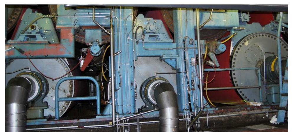
WITH A HIGH RELEASE VACUUM AS 2000 Pa, SHEET RELEASE CAN BE OPTIMIZED UP TO SPEED OF 1500-1600 m/min
